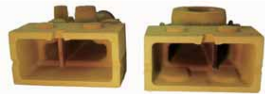
砂心成品（單側抽心結構確保砂心壁厚）
