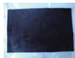
圖七 硫化後的丁基橡膠 200×300×3mm試片
