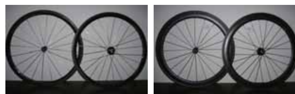
38mm輪圈高之模組化碳纖輪組 58mm輪圈高之模組化碳纖輪組
