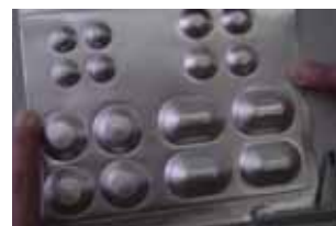
圖3 不同成型面積之AL-AL包裝材
