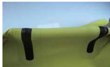
左邊為超防水FIZ拉鍊，右邊為一般防水拉鍊，在外力下右邊拉鍊產生缺口
