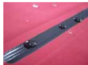
在拉鍊的齒與牙間注入藍色的PU膠
