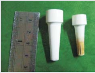
圖 4 乾壓成型造成陶瓷芯龜裂情形：左側為生胚，右側為燒結後陶瓷芯
