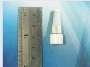
圖 2 氧氣感測器內部的錐形管狀陶瓷芯
