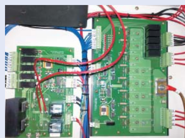
圖5 放電迴路及放電能量出力板
