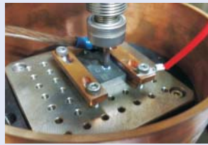
圖 7 噴出式氣中放電加工表面
