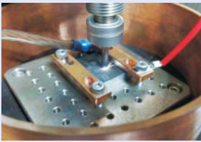
圖 6 吸入式氣中放電加工之狀態
