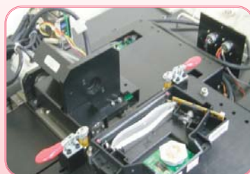
F-theta射出成型鏡片於LSU模組進行功能測試
