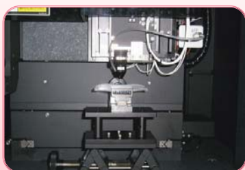
F-theta射出成型鏡片於UA3P進行自由曲面型量測
