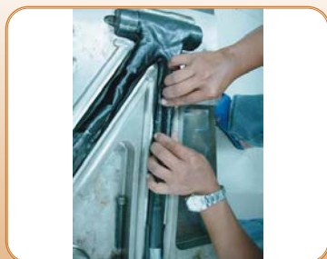
車架JIS9401疲勞測試
