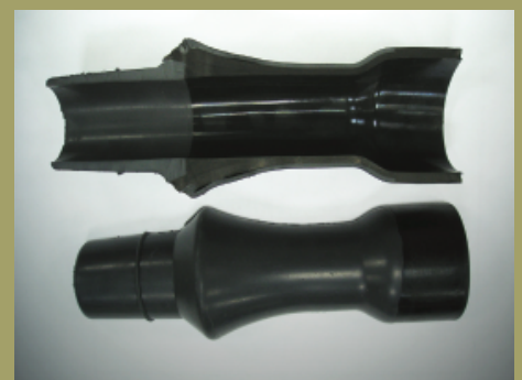
幾何應力錐試製樣品，上：解剖圖 下：外形圖
