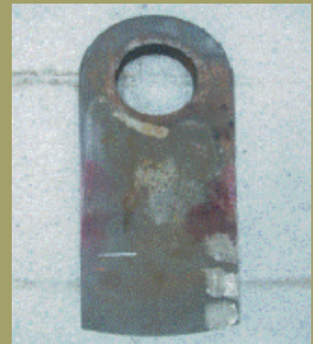
圖二、澆鑄完成之雙金屬擊錘鑄件
