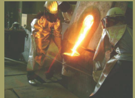
圖一、雙金屬擊錘鑄件澆鑄情形
