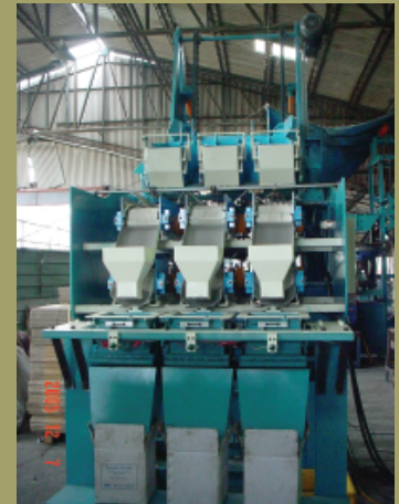
多管道荷重計量系統實體圖
