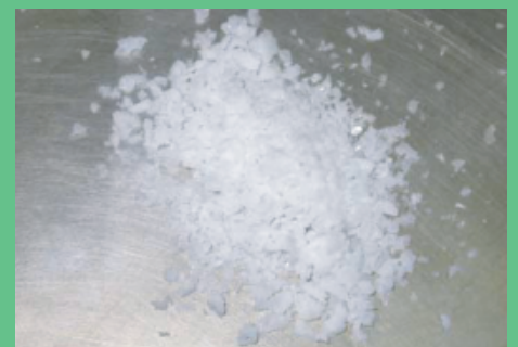
圖三：合成製造的聚乳酸 /HAp 複合材料
