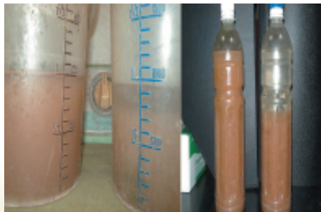
成功廠與模廠污泥沉降性之比較 (污泥濃度：成功廠 2100 mg/L，模廠 1950 mg/L)
