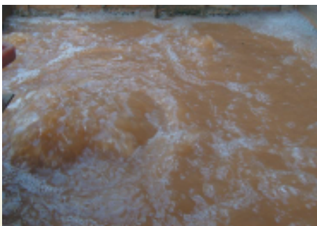
模廠利用好氧處理時活性污泥槽之情形 (產生的泡沫量較少)
