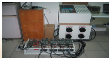
整台份伺服驅動器組裝於伺服馬達模擬測試台上測試情形
