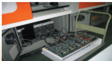
整台伺服驅動器與台中精機全電式射出機控制系統連接後測試情形
