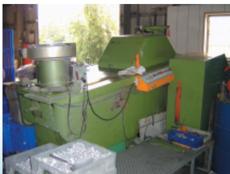
圖 3. 本計畫開發之臥式圓弧鋁管衝擊擠製設備
