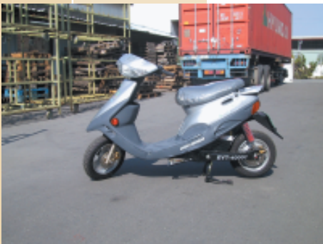
本計畫所完成的『具變繞組直驅式輪圈馬達之電動機車』
