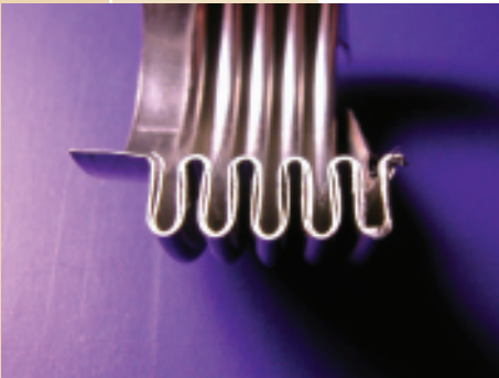
波紋管剖切面圖 -- 雙層結構
