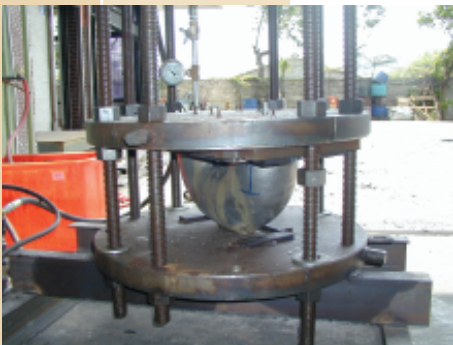
圖六彎頭成品之水壓測試
