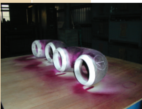
圖七彎頭成品之染色探傷
