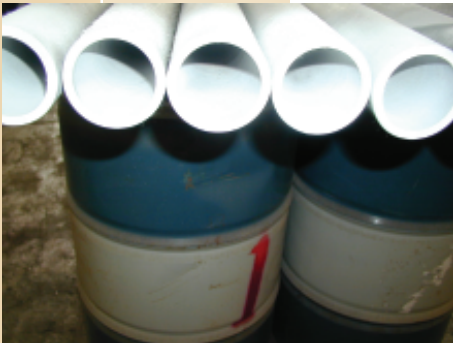
圖五乙烯裂解管成品之染色探傷
