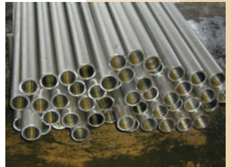
圖二 乙烯裂解管之成品
