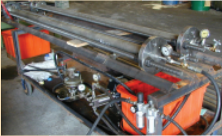
圖四乙烯裂解管成品之水壓測試
