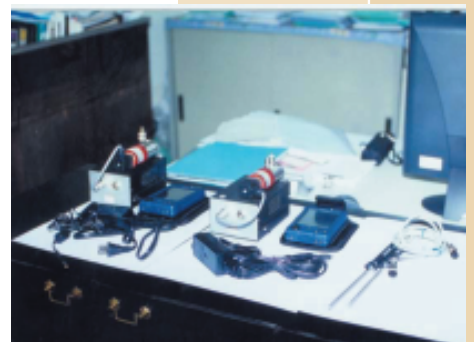
PDA 流量檢知器 2 組，包括控制盒、差壓感知器、工業級 PDA、以及熱電偶等
