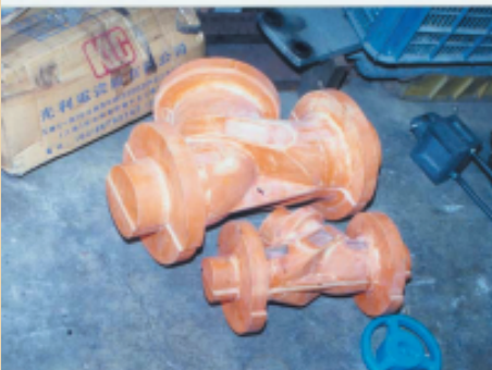
閥體鑄造模具與塑膠手輪試製品
