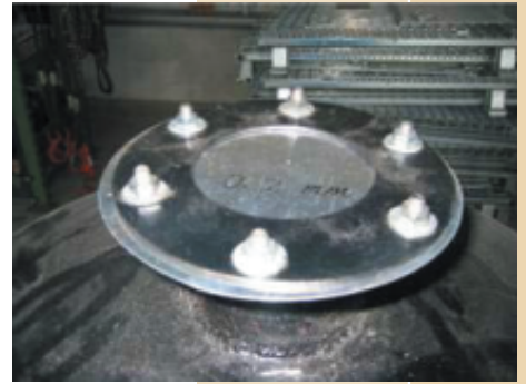
鎂合金噴砂設備防爆口設計
