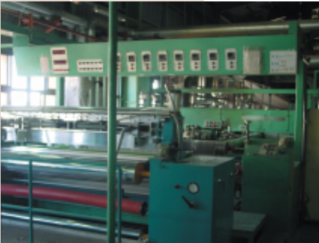
定型機搭配塗佈機使得定型機兼具塗佈用途
