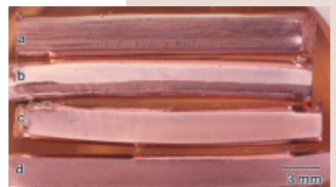
拉引速度在 90mm/min 以下可得結晶銅導線
