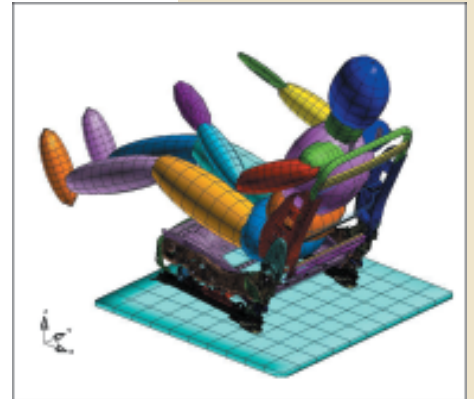
座椅後方動態衝擊人偶及座椅有限元素模型(衝擊前)
