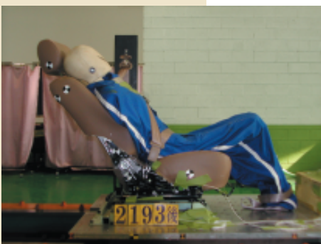
後方衝擊強度測試
