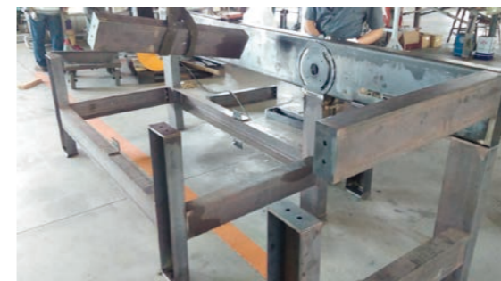
▲為技術人員重新校正架構，並準備將新的磁滾輪安裝上
