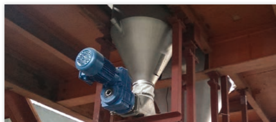
▲澱粉供給機可定量的供應澱粉或添加料與麵粉供給機的差異在機體的大小設計的概念相同
