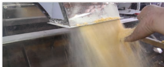
▲旋轉混合機利用每分鐘 800 轉的速度高速將水 & 粉末混合，以達到均勻混合的目標
