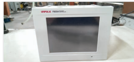
▲扣重計量控制器，可以精確的驅動供粉量，並且可以跟 PLC 連線控制
