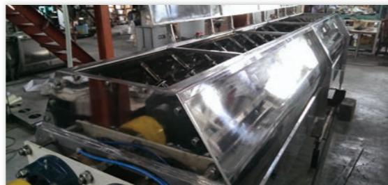
▲揉麵機利用攪拌葉片打擊麵糰，藉以產生筋性
