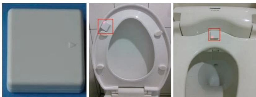
超小型震動偵測器貼於馬桶蓋上用於偵測如廁次數
