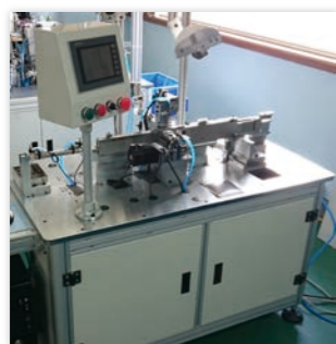
◀ 自動化組裝機超高速凸輪插針系統 每秒 50pin 高速插針。 連接器端子之組裝。
