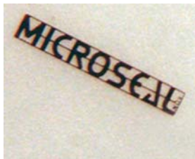
『微璽防偽粉末』單顆放大圖 ( 85 \times 535 \mu\text{m}^2 )
