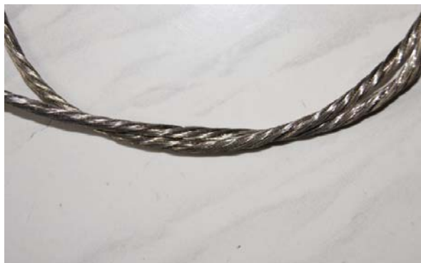
由105股線徑 \phi 0.254mm 絞合而成之導體
