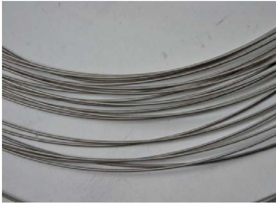
完成鍍鎳之導體線 (φ0.7mm, 鍍層厚0.05mm)
