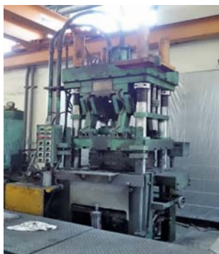
鋁碳化矽複材之現場壓鑄情形
