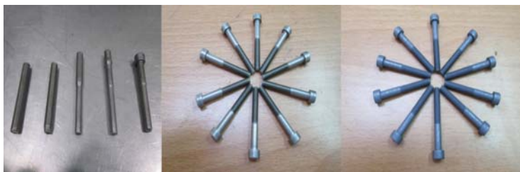
超合金A286太空扣件之各道次半成品、熱處理後產品與表處後
