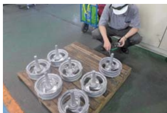
壓鑄鋁輪圈之冷卻溫度監測
