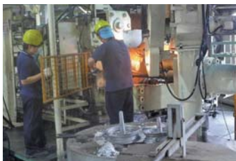
高強韌機車鋁圈之現場壓鑄情形
