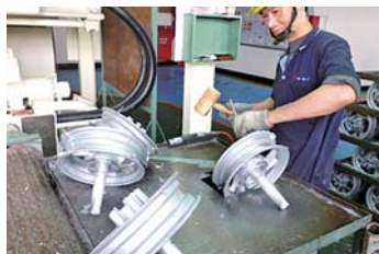
去除鑄件之溢流井與逃氣道
