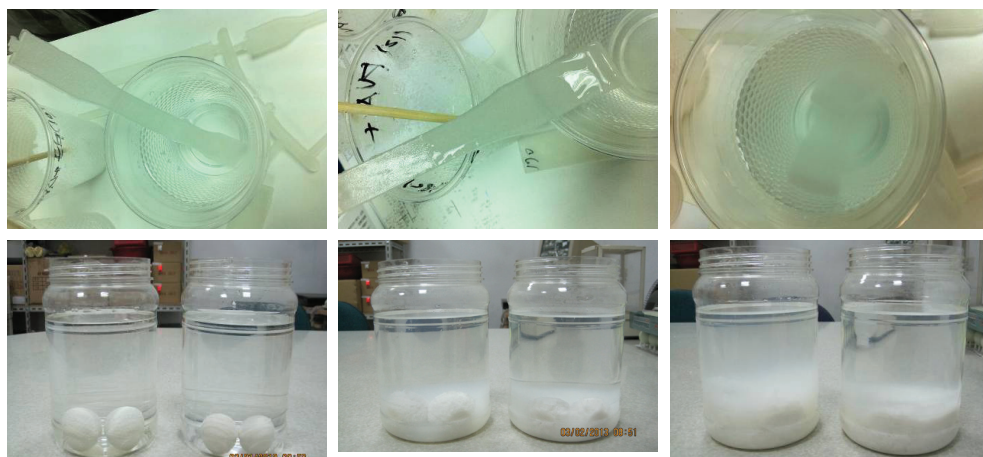
圖 3、射出成型後之標準試片、球心、成球在不同時間的水溶性試驗結果。
