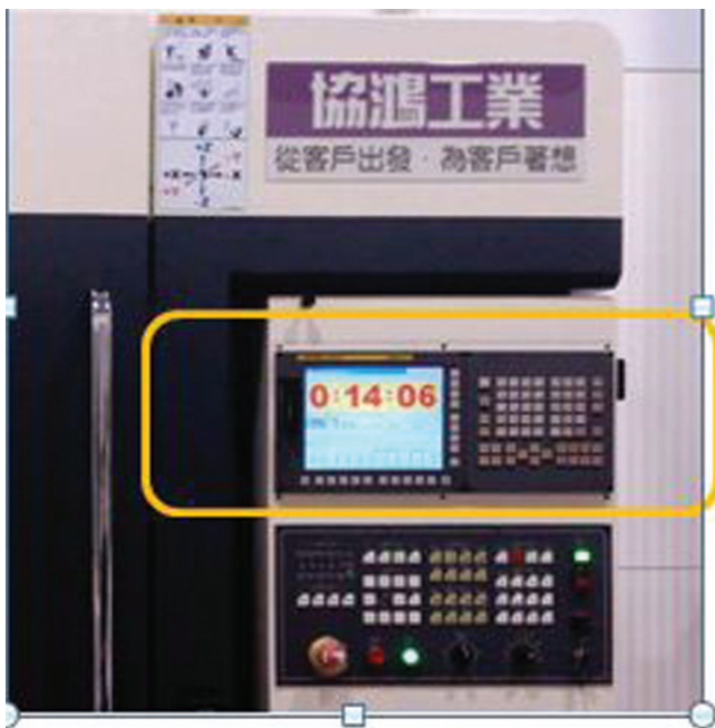
顯示在控制器畫面方式 (最大範圍9時59分59)
