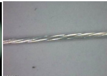
7股線徑 \phi 0.016\text{mm} 絞合而成之導體
