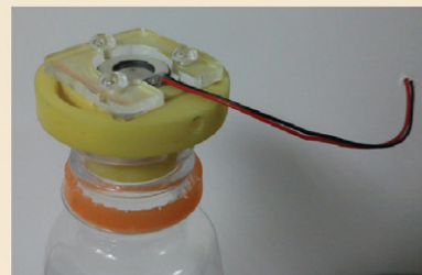
圖：噴霧測試的功能模型組
