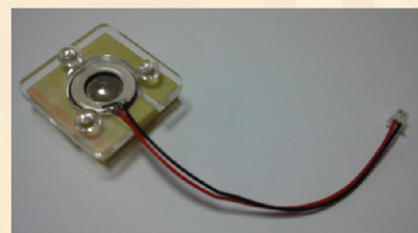
圖：可搭配更換不同壓電元件的快拆件
