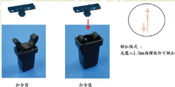
圖 1. 半自動機構示意說明圖
