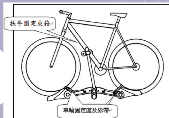
圖 2、鎖固功能規格圖
