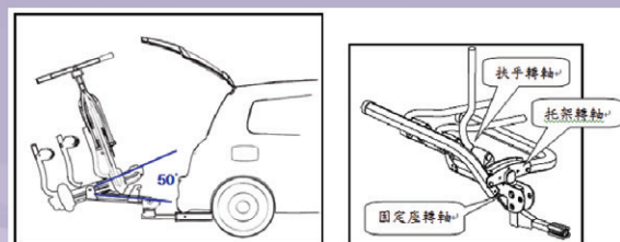
圖 3、打開後門不需要拆卸車架的機構
