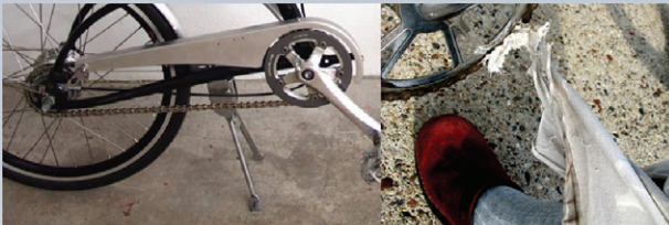
(5)內變速, 固定的鍊條張力能降低鍊條脫落及保養的機率標準配備：內變速系統 (3速-8速)
